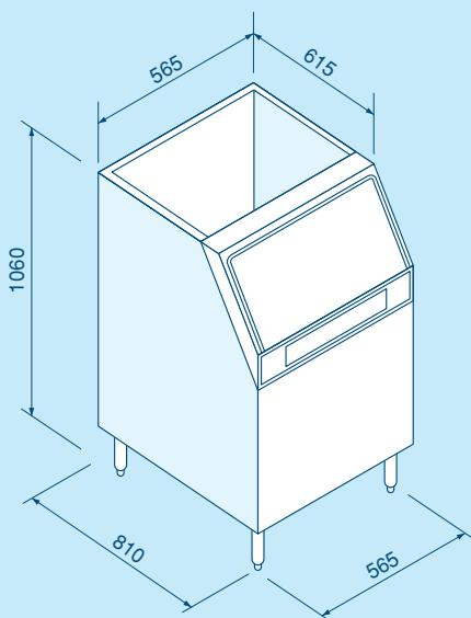
Capacità di deposito sino a 100 kg in dimensioni LxPxH **565x810x1060** mm.
