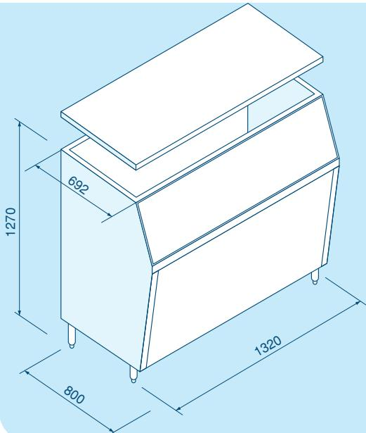
Capacità di deposito sino a 467 kg in dimensioni LxPxH **1321x801x1270** mm.
