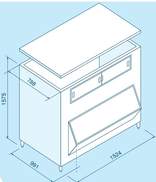
Capacità di deposito sino a 676 kg in dimensioni LxPxH **1524x991x1537** mm.
